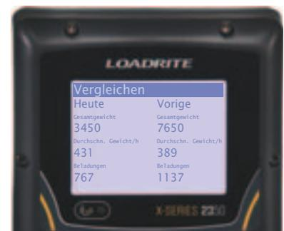
Die Leistungsdaten werden gespeichert, sodass der Bediener seine Leistung mit früheren Leistungen, seinem Durchschnitt und der besten Schicht vergleichen kann
