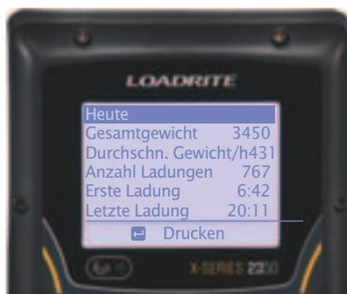
Feedback mit Kennzahlen für den Bediener im Führerhaus während der Schicht
