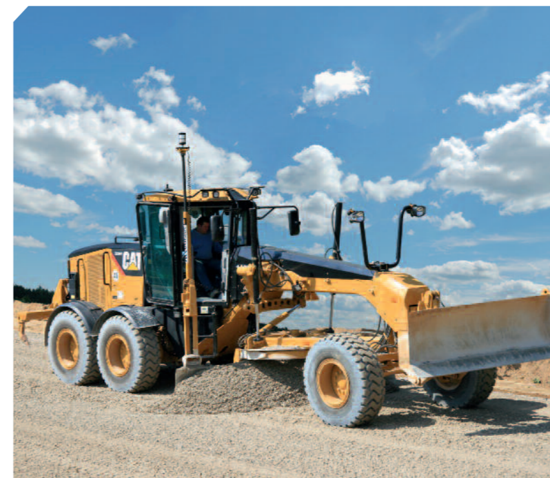
Cat Motorgrader 140M AWD mit 3D-UTS-Steuerung
