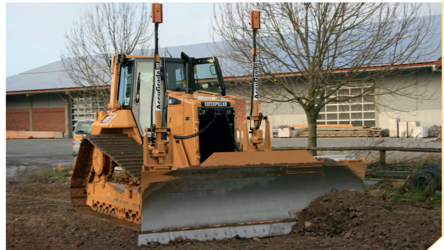
Cat D6N LGP mit Dual-Lasersteuerung
