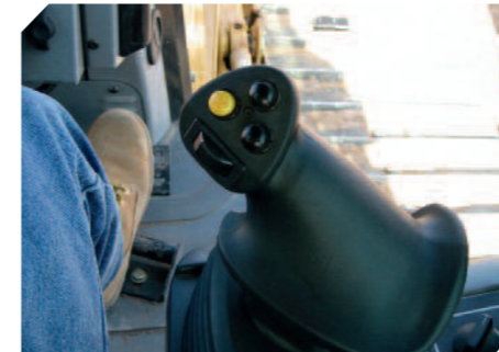
Cat Dozer D7E, Bedieneinheit in Sichtlinie zu den beiden Schildecken. Joystick, Automatik An/Aus (gelber Knopf), schrittweises Anheben/Absenken des Schildes (schwarze Knöpfe)
