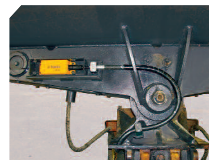
Schwenklöffelkontrolle mit Winkelsensor AS450 im robusten Stahlschutzgehäuse
