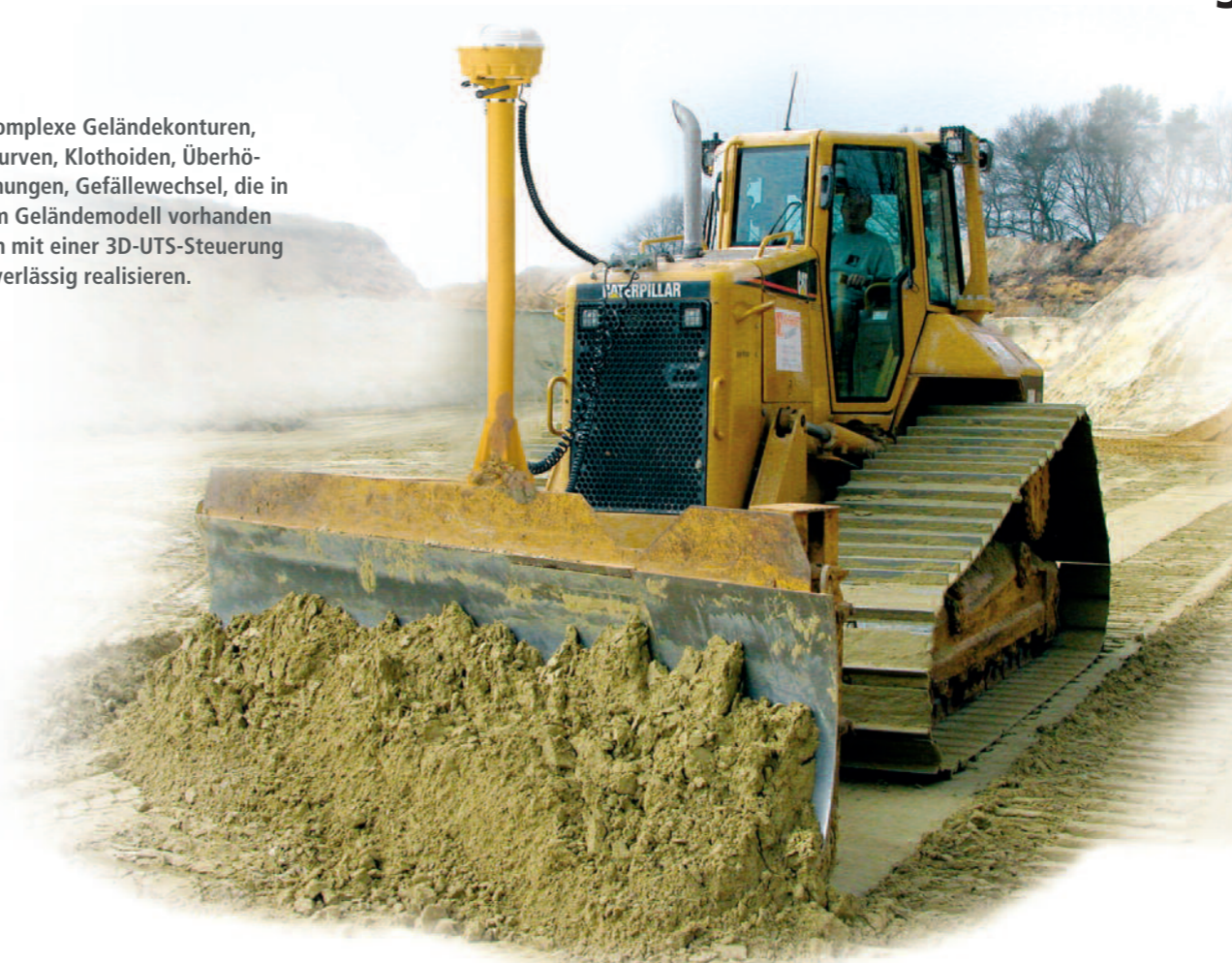
Dieses Ein-Mast-Konzept bietet Ihnen höchste Effizienz im Tagesgeschäft. Der Wechsel je nach Aufgabenstellung zwischen 3D-UTS- oder 3D-GNSS-Steuerung (GPS + GLONASS = GNSS) beträgt dabei nur wenige Minuten.
