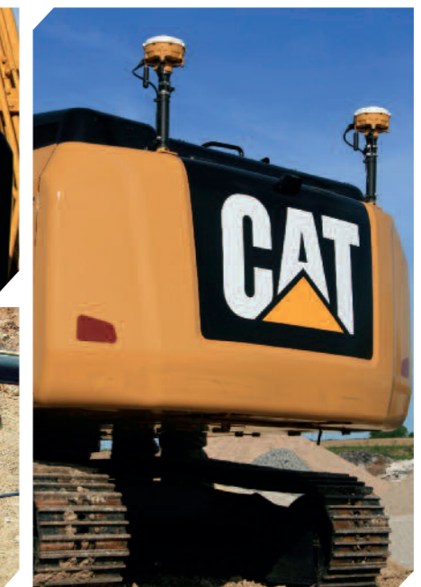
MS992 GNSS-Empfänger (Zwei-Mast-System)
