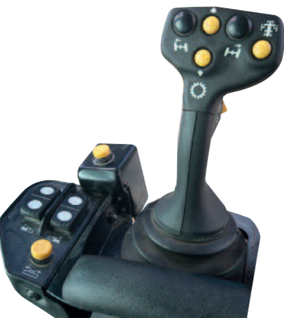
Bedienelemente für den Automatikbetrieb sind bereits ab Werk in Cat M-Gradern integriert.
