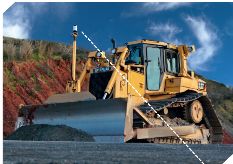
Cat D6T LGP mit 3D-UTS-Steuerung
